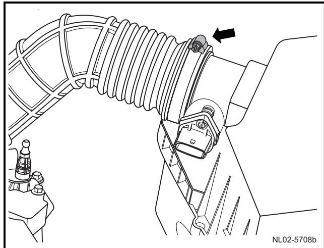
2) 拆卸空气滤清器总成固定螺栓，取下空气滤清器总成。
